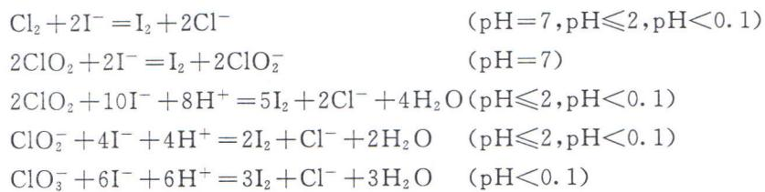
然后用硫代硫酸钠作滴定剂，分步滴定反应产生的 I<sub>2</sub>。
